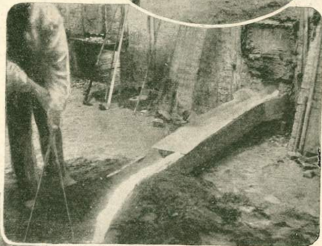
Completamento della forma. Il metallo liquido scorre dalla fornace verso la forma.
