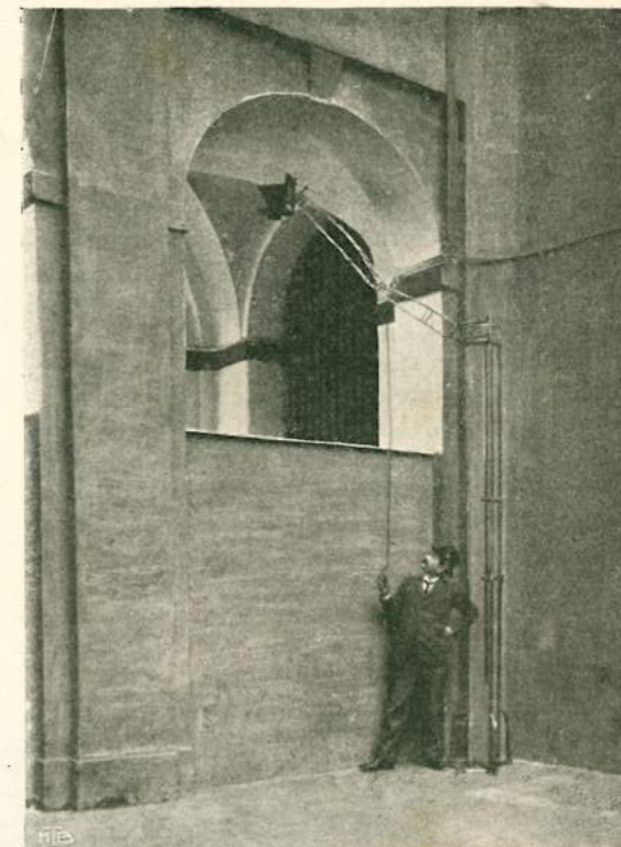
Fig. 14. Il cavalletto « Ellero » in funzione per la fotografia in un ambiente diverso da quello in cui trovasi chi lo fa agire.
